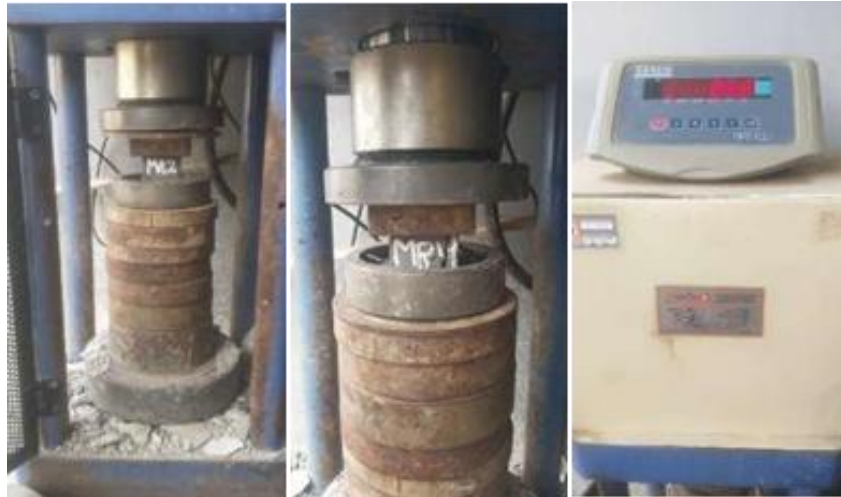
Fig. 2- Rotura de cubos de mortero
