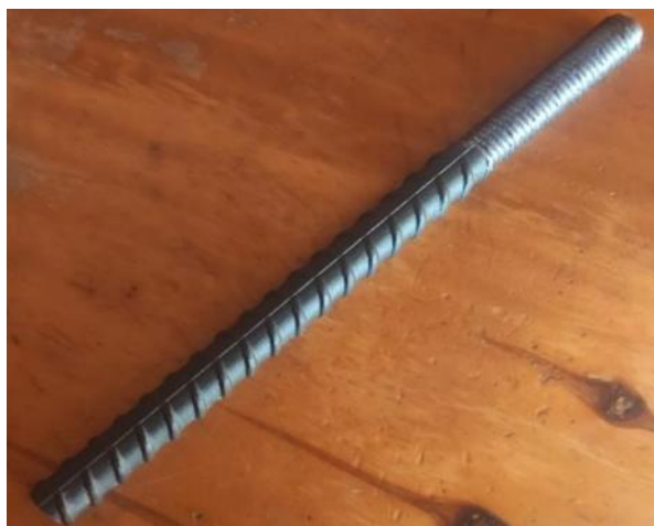
Fig. 3- Roscado en varilla corrugada de acero ASTM A615 de 15,90 mm.
