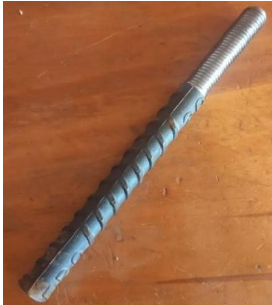
Fig. 4- Roscado en varilla corrugada de acero ASTM A615 de 19,05 mm.
