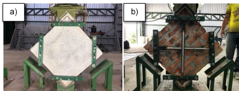
Fig. 7- Muretes. a) Colocación en marco de reacción, b) Instalación de LVDT.
