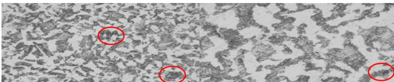
Fig. 8- Incrustaciones de grafito en la probeta de 15,90 mm de acero ASTM A615: (a) aumento de 500x y (b) aumento de 1000x.
