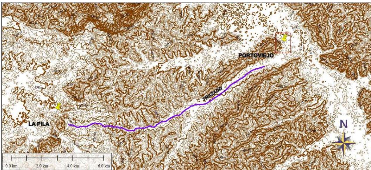
Fig. 4- Vista del Trazado (en violeta) con Curvas de Nivel cada 20 metros generado en Global Mapper.
