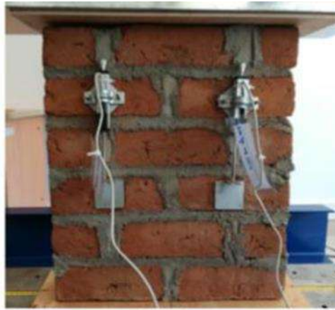
Fig. 1- Ensayo de compresión del murete. Fuente: [5].
