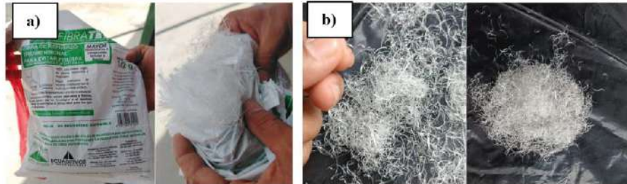
Fig. 3- a) Fibra sintética EPS FIBRATEX y b) Fibra de PET reciclado, elaborada artesanalmente.
