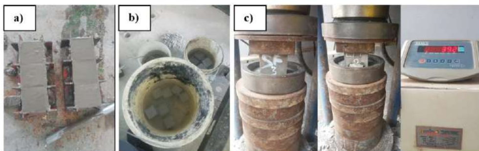
Fig. 5- a) proceso de elaboración, b) curado y c) ensayo de los cubos de mortero
