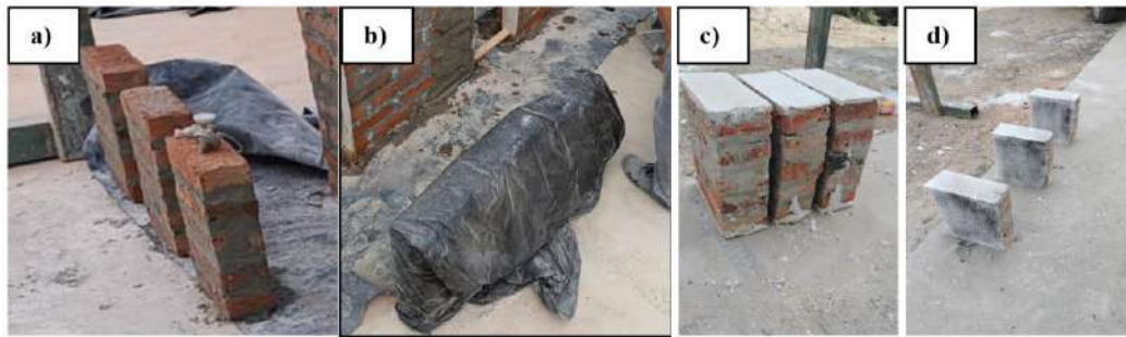
Fig. 9- Prismas: a) elaboración, b) proceso de curado, c) refrentado y d) pintado para DIC
