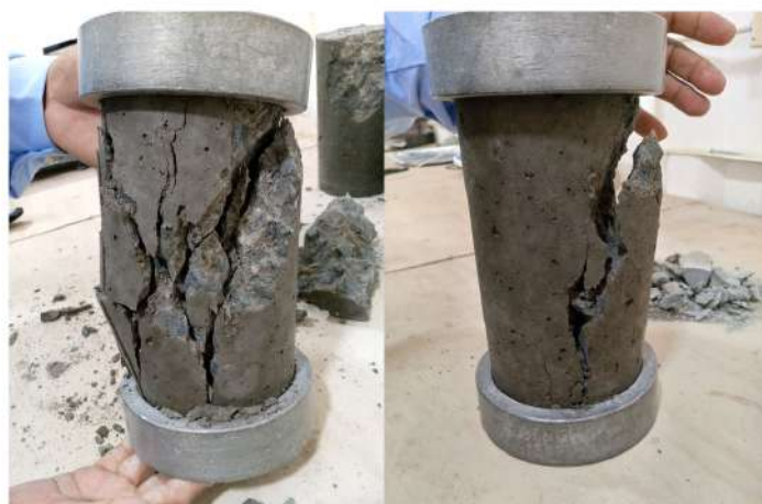
Fig. 9- Fisuración de especímenes.
