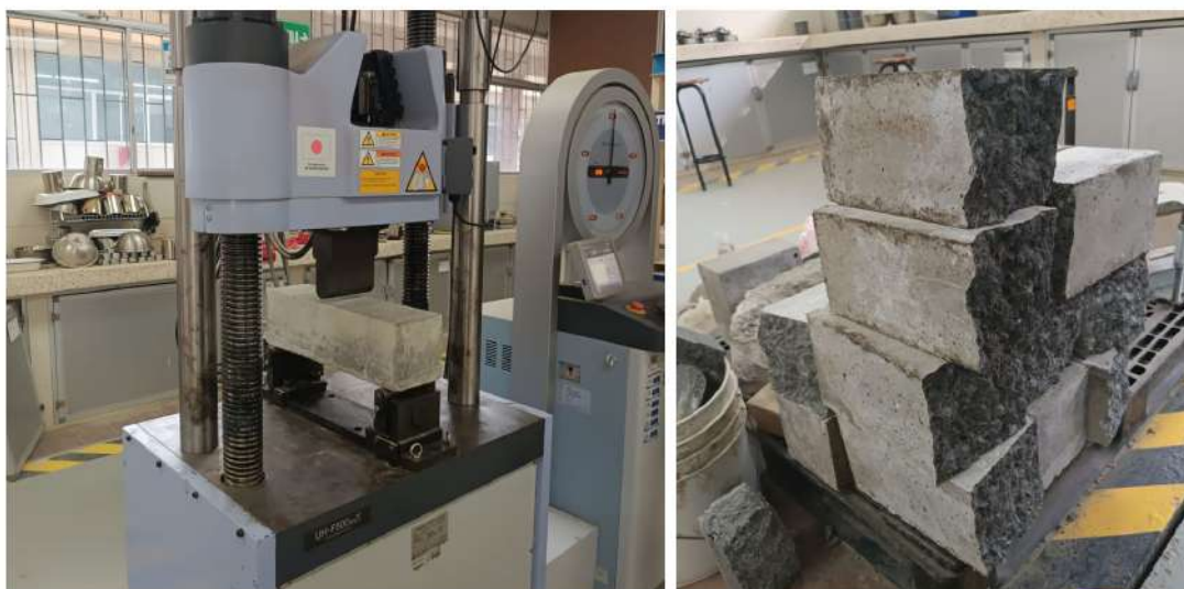
Fig. 7- Ensayo a través del módulo de rotura
