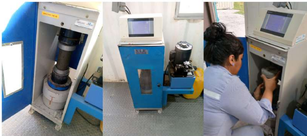
Fig. 6- Ensayo a compresión del hormigón
