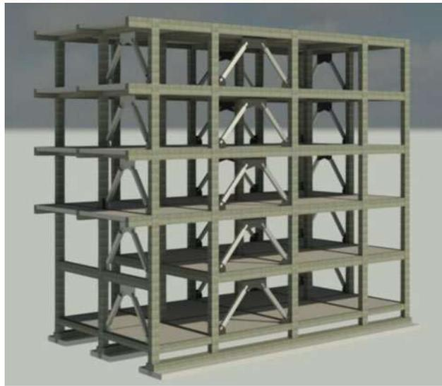
**Figura 4.** Vista en 3D de la estructura reforzada
