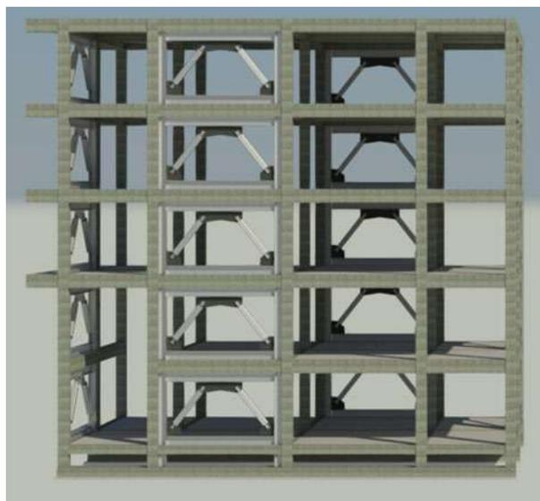
**Figura 6.** Modelo 3D de la estructura reforzada con marcos de acero y BRB
