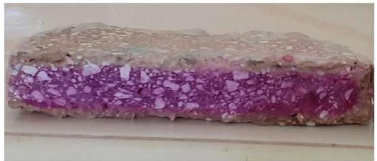
**Figura 7:** Carbonatación en mortero expansivo MORDRY JUNT endurecido y puesto en servicio. Izquierda: Pc homogéneo según Anexo A de la NC 355: 2004. Derecha: testigo cortado a 25mm y con fenolftaleína aplicada.
