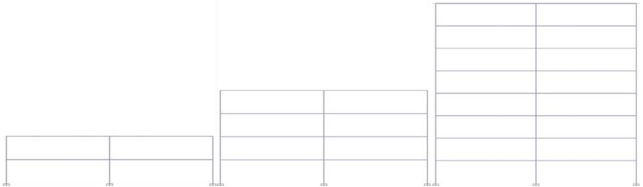
**Figura 11:** Modelado Columna ancha para relaciones  $h/l= 1, 2$  y  $4$
