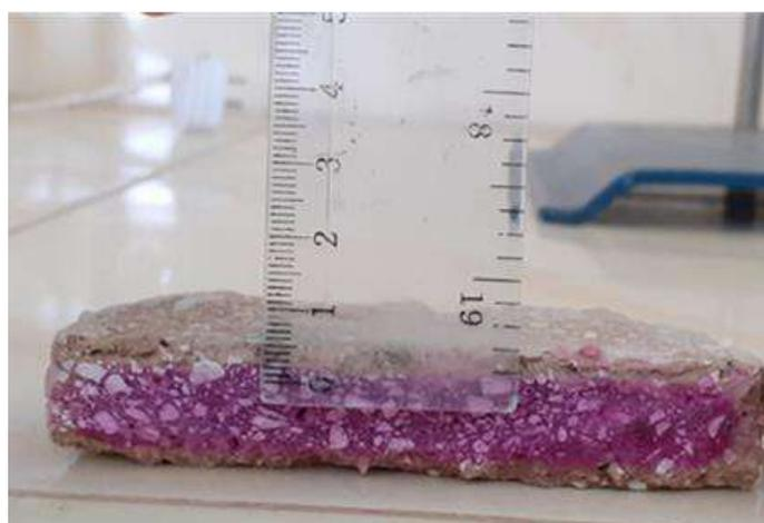
**Figura 10:** Medición del frente carbonatado.
