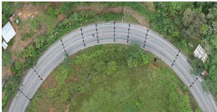
Figura 4: Ancho de carril y berma medido en AutoCAD Civil 3D
