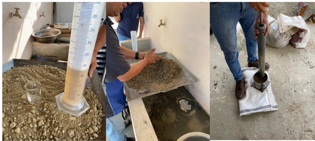
Figura 2. Mezcla de enzimas con el material granular y su respectivo ensayo de proctor.
