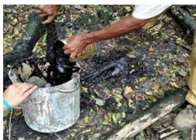
**Figura 2.** Afloramiento del asfalto nativo de la zona El Peñón donde se tomó la muestra para ensayo.
