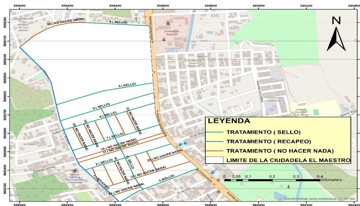
Figura 9 Tratamientos propuestos para las vías de pavimento flexible de la Ciudadela El Maestro.
