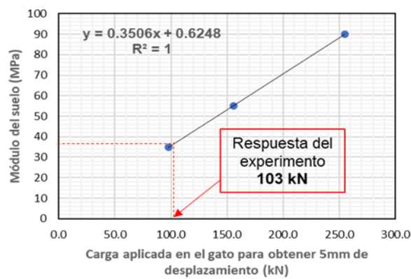
Figura 14: Carga aplicada para obtener 5.0 mm de deflexión teniendo en cuenta el intervalo de confianza de las resistencias del suelo
