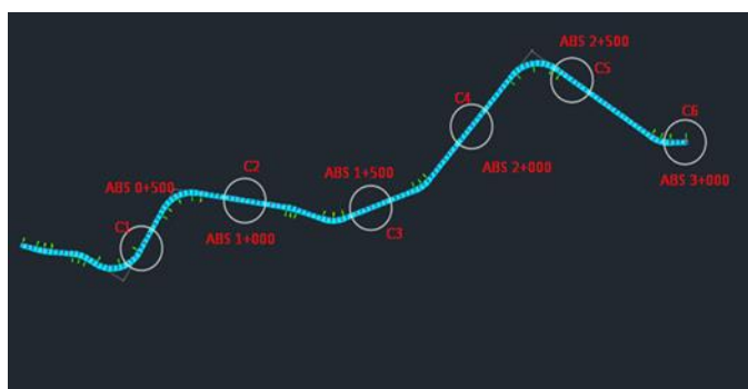
Fig. 4: Puntos de ubicación de la extracción de calicatas
