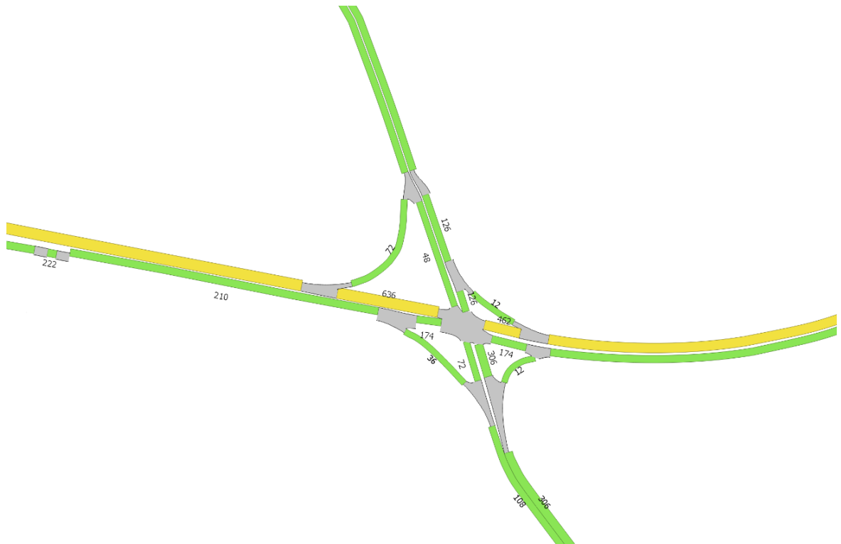
Figura 14: Simulación nivel de servicio Vía Pajonal
