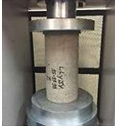
**Figura 1.** Probeta cilíndrica ensayada. Fuente: [11]
