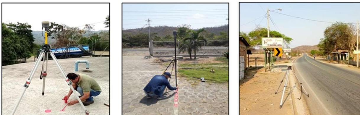
**Figura.2:** Posicionamiento estático con GPS
