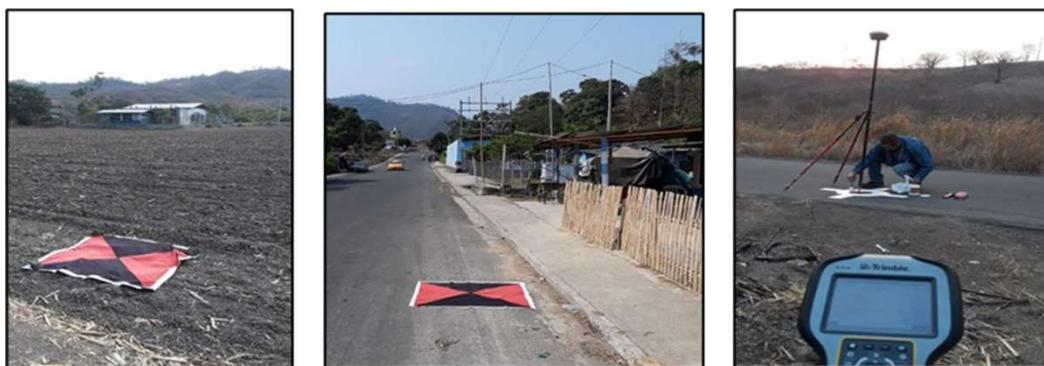
**Figura 4:** Puntos de apoyo fotogramétrico (PAF)
