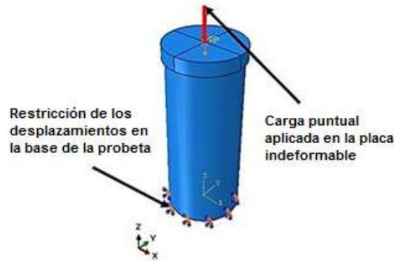
**Figura 4.** Condiciones de borde y carga aplicada al modelo. Fuente: Elaboración propia.
