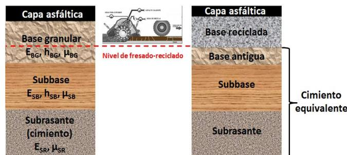
**Figura 3.** Esquema de la estructura antigua y la nueva, formada por la base reciclada, y la capa asfáltica, apoyadas sobre el cemento equivalente.
