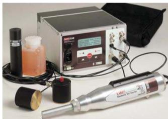
**FIGURA 1: ESCLERÓMETRO O MARTILLO DE REBOTE [19]**
