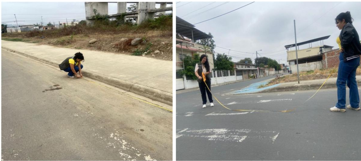
Fig. 3. Recorrido para medición de fallas en los tramos evaluados.
