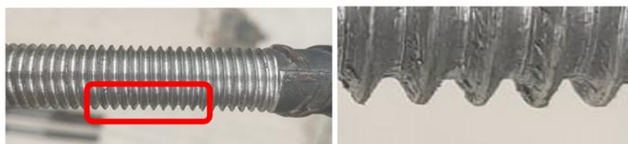
Fig. 5- Imperfecciones en el roscado causadas por la irregularidad geométrica de la varilla ASTM A615.
