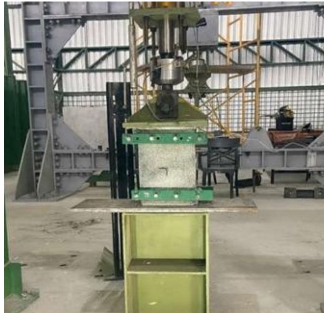
Fig. 4- Prisma listo para ensayar en marco de reacción.
