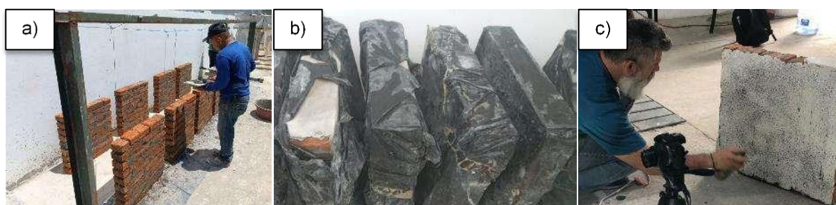
Fig. 6- Proceso constructivo de muretes. a) Construcción, b) Curado, c) Pintado para fotogrametría.
