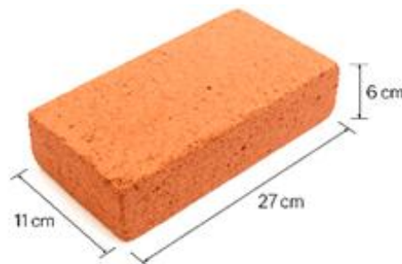
Fig. 1- Dimensiones de ladrillo macizo
