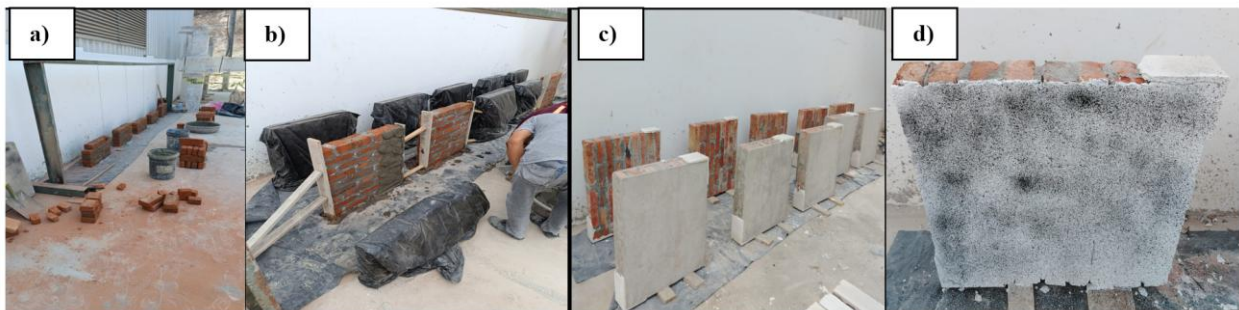
Fig. 6- Muretes: a) elaboración, b) proceso de curado, c) refrentado y d) pintado para DIC
