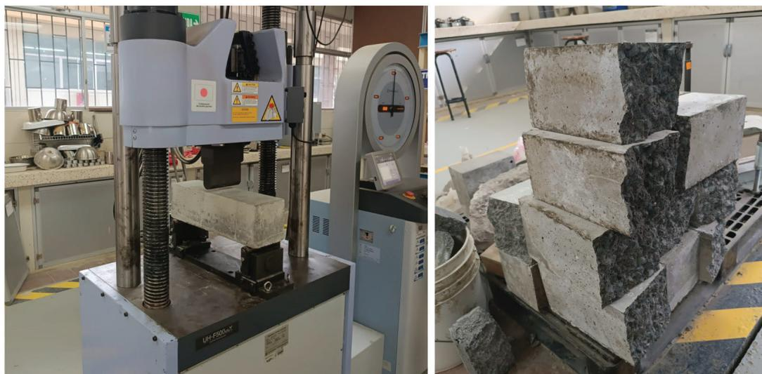
**Fig. 7-** Ensayo a través del módulo de rotura
