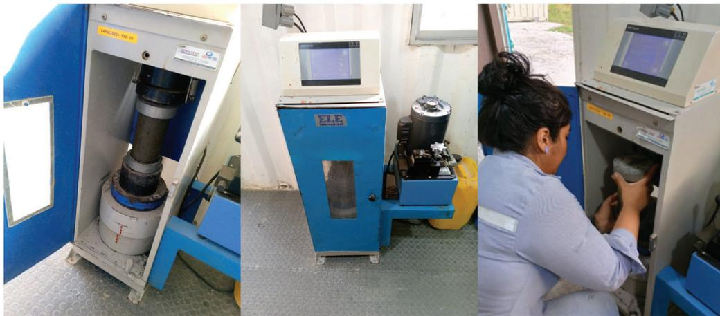
**Fig. 6-** Ensayo a compresión del hormigón
