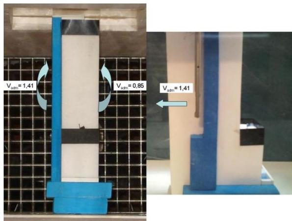
**Figura 8:** (izquierda) la intensidad del viento se incrementa un 41% sobre el lado norte y se reduce al 85% en el lado sur; (derecha) vista norte de la maqueta donde se incrementa la velocidad del viento
