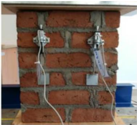
Fig. 1- Ensayo de compresión del murete. Fuente: [5].
