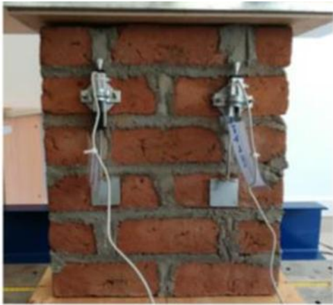
Fig. 1- Ensayo de compresión del murete. Fuente: [5].
