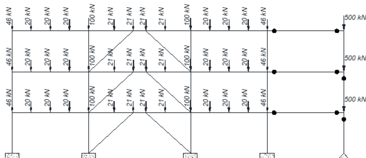
Figura 3: Esquema de cargas puntuales aplicadas.
