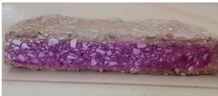
Figura 7: Carbonatación en mortero expansivo MORDRY JUNTA endurecido y puesto en servicio. Izquierda: Pc homogéneo según Anexo A de la NC 355: 2004. Derecha: testigo cortado a 25mm y con fenolftaleína aplicada.
