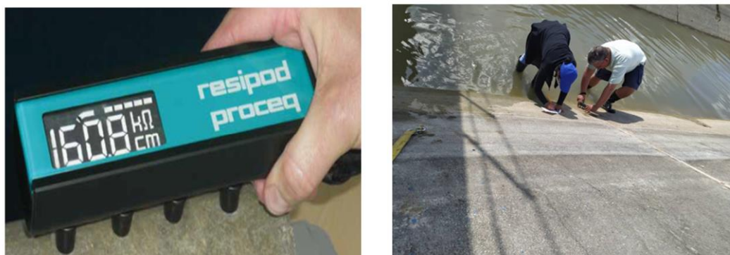
Figura 6: Ensayo de resistividad in situ
