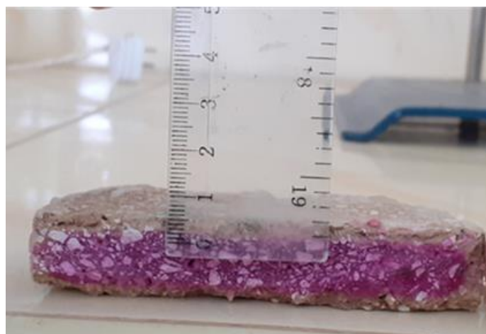
Figura 10: Medición del frente carbonatado.
