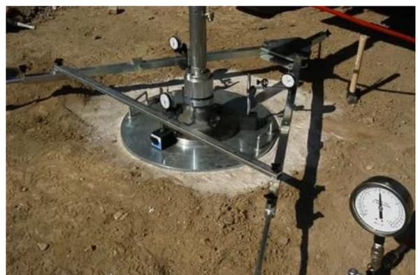
Figura 2. Imagen del Ensayo de carga con Placa Estática [13].
