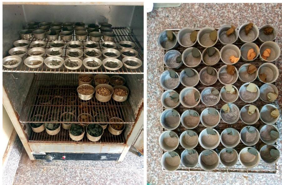
**Figura 2:** Secado de las muestras para obtención de los Límites Atterberg
