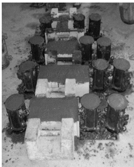
**Figura 2:** Probetas normalizadas y atípicas con moldes de PVC para los cuatro diseños de mezclas
