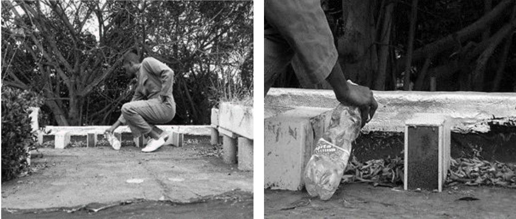
**Figura 3:** Fotos con proceso de aplicación del aerosol con solución salina (Fuente: elaboración propia)
