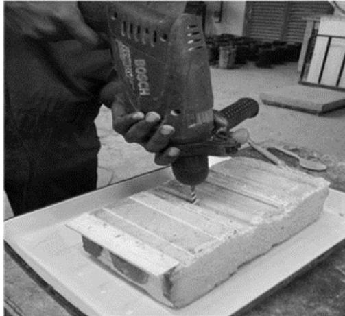
**Figura 4:** Extracción de muestras para el ensayo de concentración de iones cloruros
