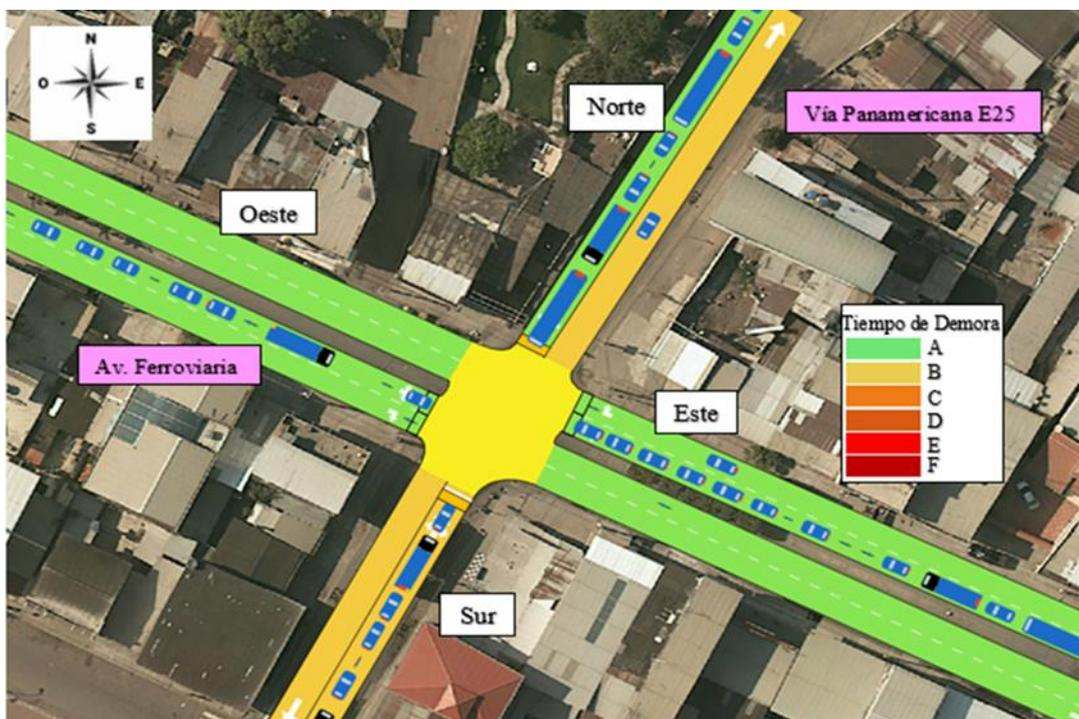
**Figura 7:** Simulación nivel de servicio de la intersección
