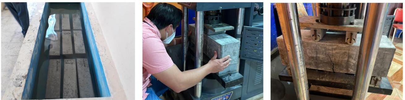
**Figura 5:** Ensayo de resistencia a flexión (módulo de rotura)
