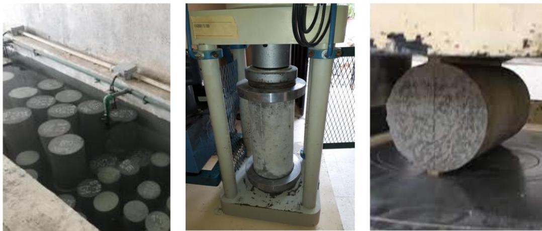
**Figura 4:** Ensayo de compresión uniaxial y tracción indirecta en los especímenes
