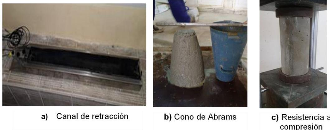
**Figura 2:** Protocolos de ensayo en hormigones
