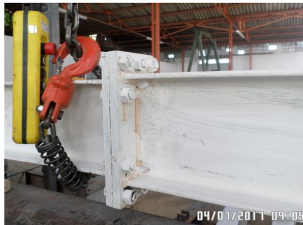
**Figura 13:** CESC después de ser ensayada
