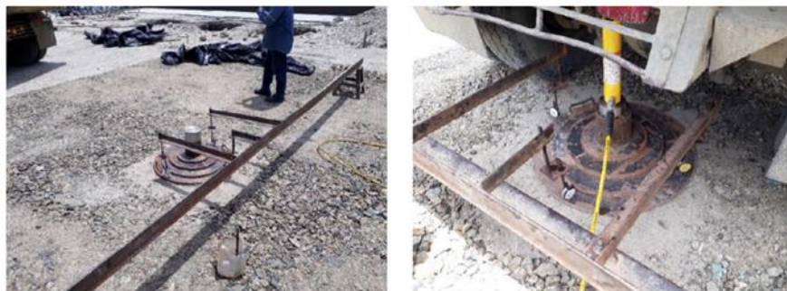
Figura 4: Preparación del ensayo con placa de carga estática.
