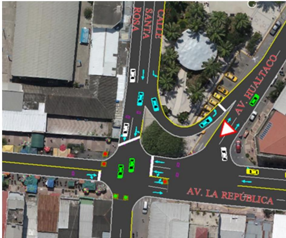
**Figura 6:** Simulación en Synchro de la intersección con el giro protegido. Fuente: Elaboración propia.
