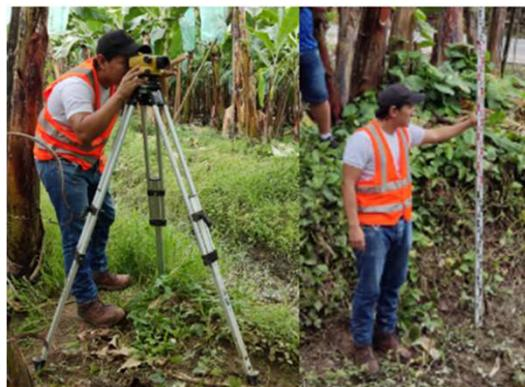
**Figura 6:** Nivelación Geométrica
