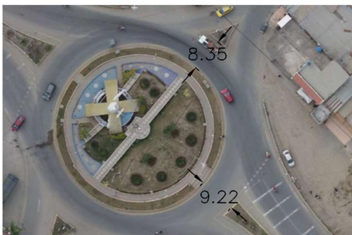
**Figura 3:** Ancho de circulación afectado por isletas secundarias
