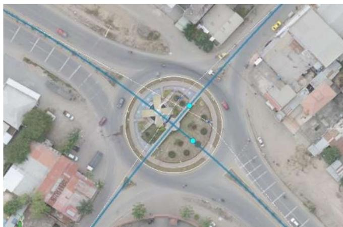
**Figura 8:** Trazado de ejes viales
