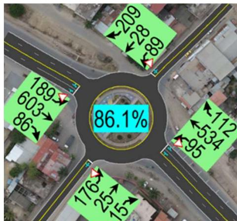
**Figura 5:** Resumen esquemático de tráfico en la rotonda y relación uso capacidad (v/c)
