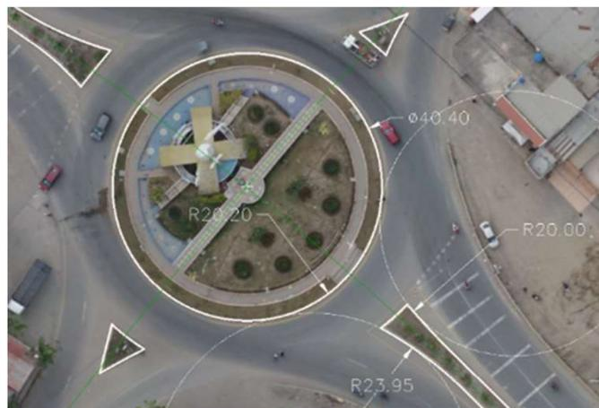
**Figura 6:** Estructura existente, radios de ingreso y dimensión de isleta central.
