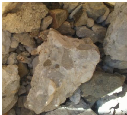
Figura 3: Residuos de la demolición de una cubierta de hormigón armado
