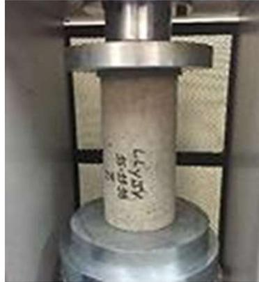
**Figura 1.** Probeta cilíndrica ensayada. Fuente: [11]
