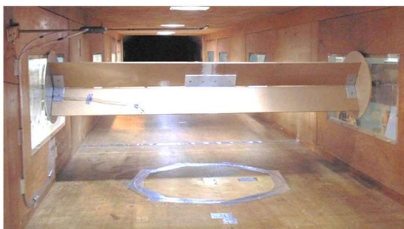
**Figura 3:** Ensayo de coeficientes de presión sobre secciones de perfiles.
