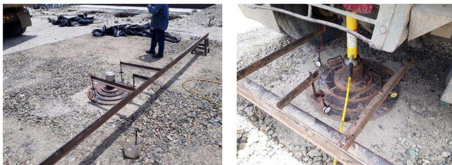
**Figura 3:** Preparación del ensayo con placa de carga estática.
