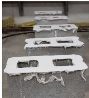
**Figura 11:** Refrentado de la cara superior del prisma [16]
