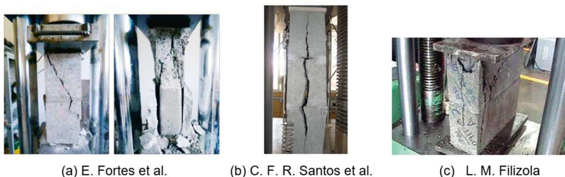
**Figura 14:** Tipos de fallos en prismas. (a) Fallo de prismas de bloques de alta resistencia. De izquierda a derecha: prisma sin macizar y prisma macizado [11]. (b) Grietas verticales [54]. (c) Fallo por desprendimiento de la cara lateral [47]
