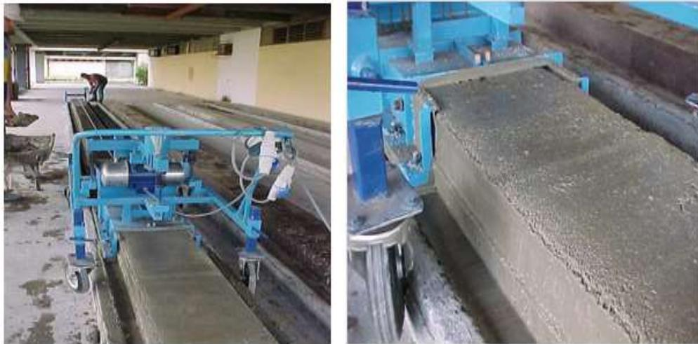
**Figura 2.** Hormigonado del elemento con máquina vibro compactadora
